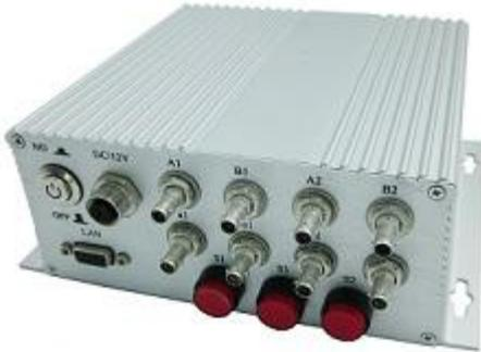
1553B 总线切换器是自主研发的产品,本设备是为多条 1553B 数据总线切换而研制的性能先进和高可靠性的 1553B 总线切换产品。该设备可实时完成并支持八个 1553B 独立接口之间的信号固定互联与切换;该设备亦可使用标准的以太网电缆直接与远程计算机连接并进行远距离网络遥控集中操作 1553B 总线切换。
