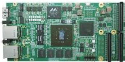
TJ-A664-XXX 系列 ARINC 664 接口卡是一款自主研发板卡。是一款符合 ARINC664Part7 标准的数据接口卡，支持基于 ARINC 664 协议的数据接收和发送，能够实现大部分的数据通信操作功能。
